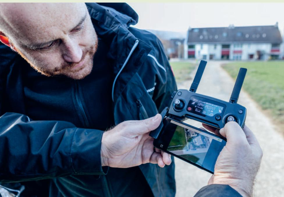
Eine Fotodrohne ist in der Lage, ein Gelände detailliert zu vermessen. Mit den gewonnenen Daten erarbeiten wir ein 3-D-Modell des Geländes.
